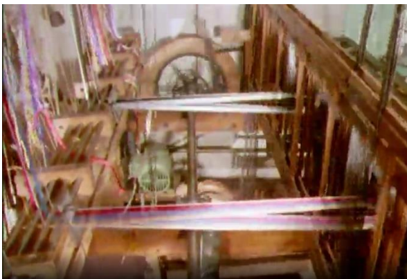
Abb. 20: Fachbildung beim Webvorgang von Bändern
