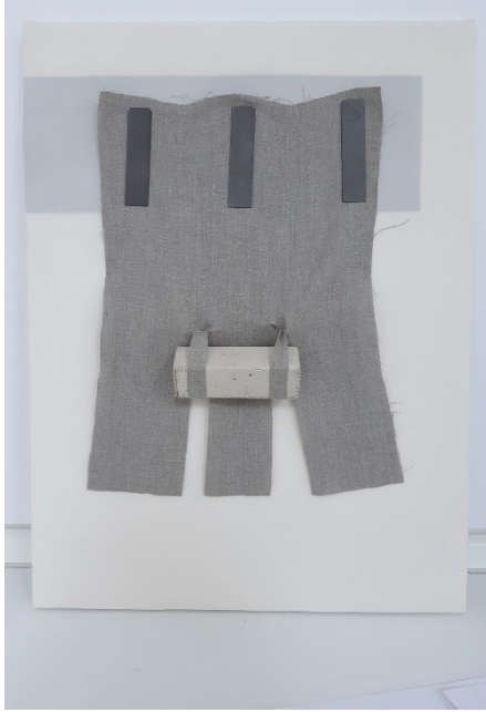
Abb. 190: Belastungstest mit einem Gewicht auf dem Modell der Montageplatte mit Eisenplatte und Magnetstreifen
